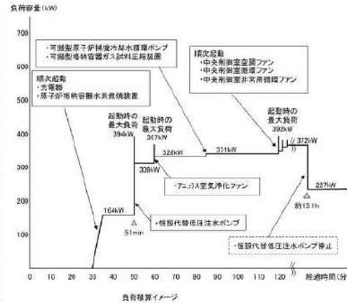
また、仮に全交流動力電源喪失の重畳を考慮した場合、「雰囲気圧力・温度による静的負荷（格納容器過圧破損）」と同様の対応となる。重大事故等対策に必要な負荷として約540kW必要となるが、代替非常用発電機の給電容量2,760kW(3,450kVA)未満となることから、必要負荷に対しての電源供給が可能である。
