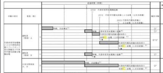
図 2.14.42 代替所内電気設備による交流の給電（代替非常用発電機）のタイムチャート*
