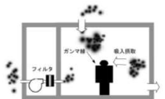
図7.9 外気から取り込まれた放射性物質による中央制御室内での被ばく経路
