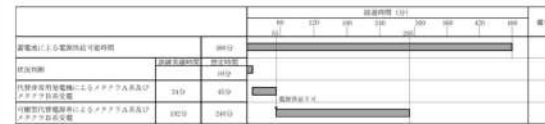
第2図 可搬型代替交流電源設備（可搬型代替電源車）による非常用高圧母線（メタクラA系及びメタクラB系）受電タイムチャート
