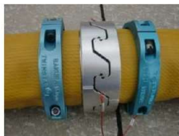
可搬型ホース（150A）接続後
