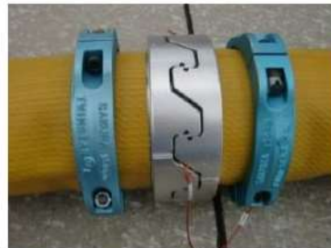
可搬型ホース（150A）接続後
