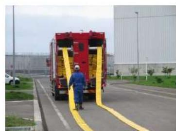
ホース延長・回収車(送水車用)による可搬型ホース敷設
