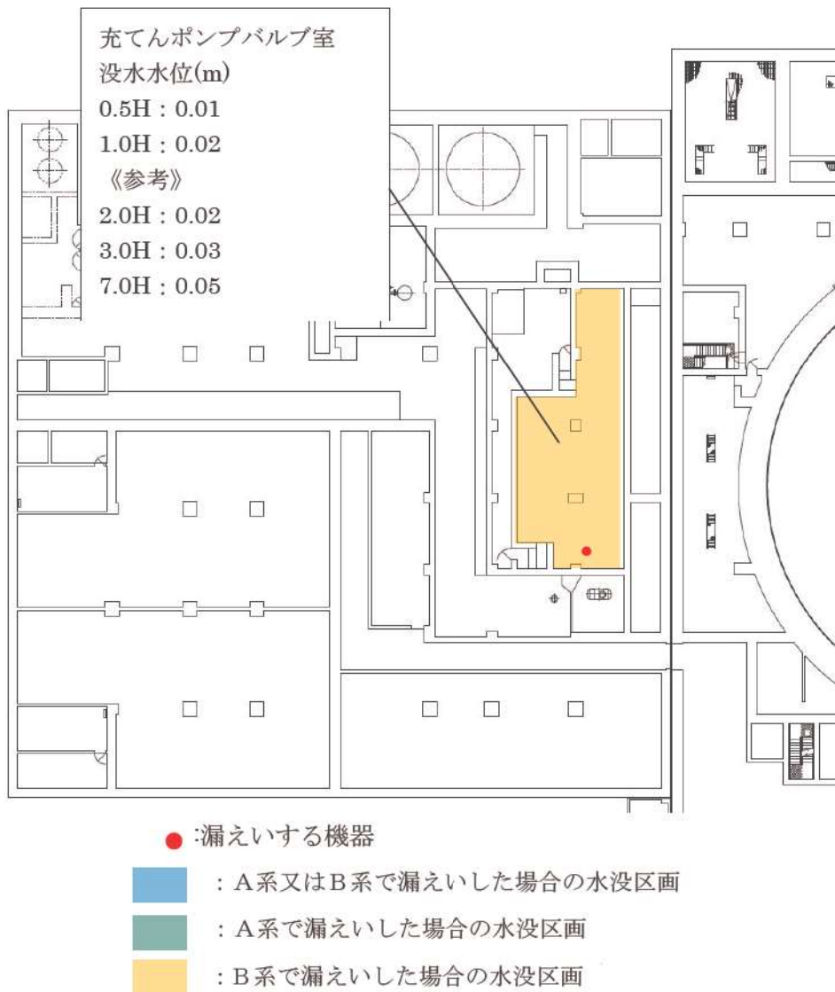
図3 溢水評価 (T.P. 10.3m 中間床) (ISLOCA が余熱除去系の B 系で発生)
