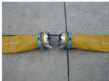
可搬型ホース（150A）接続前
