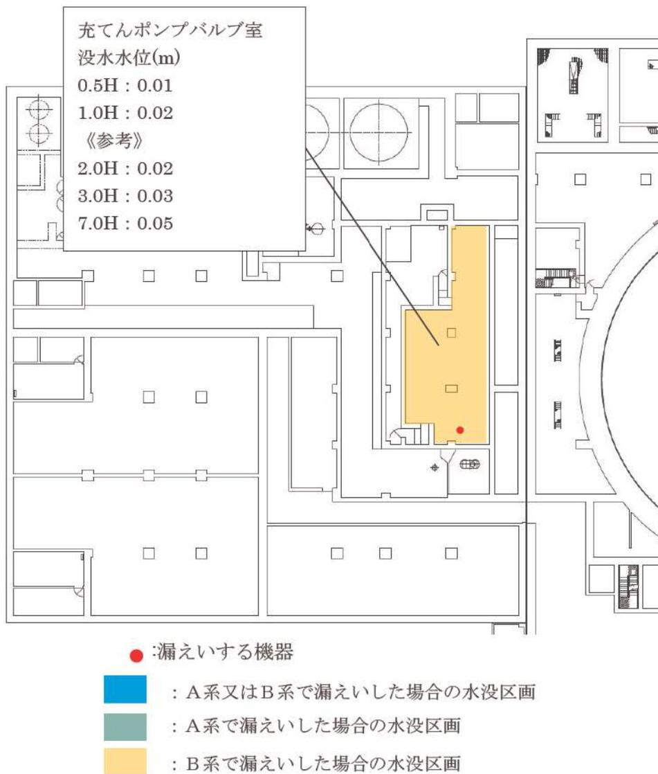
図3 溢水評価 (T.P. 10.3m 中間床)
