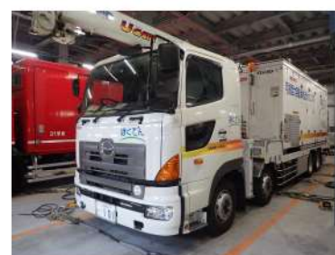
可搬型大容量 海水送水ポンプ車
