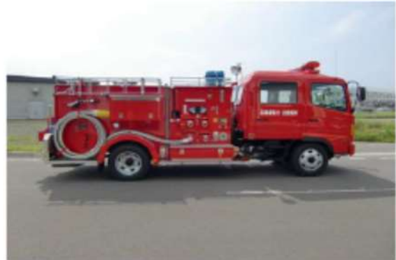
第 2 図：水槽付消防ポンプ自動車
