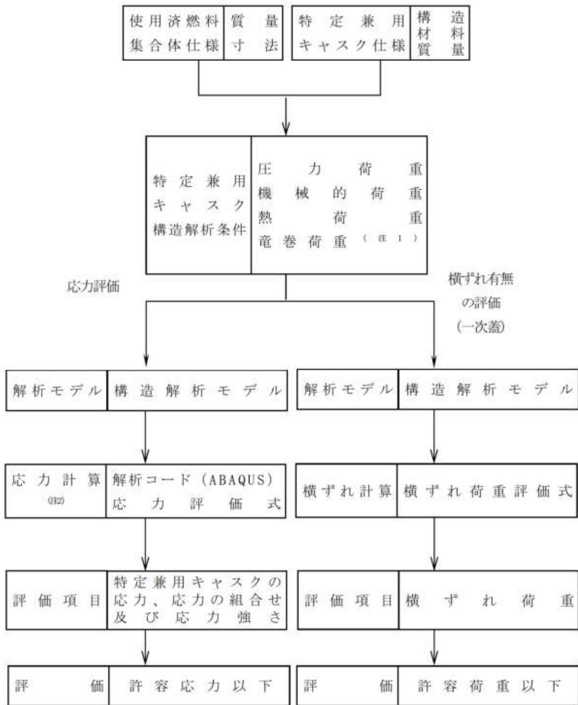
第1図 竜巻荷重作用時の機能維持評価フロー
