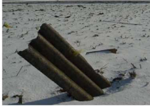
周囲の田に散乱した屋根ふき材
