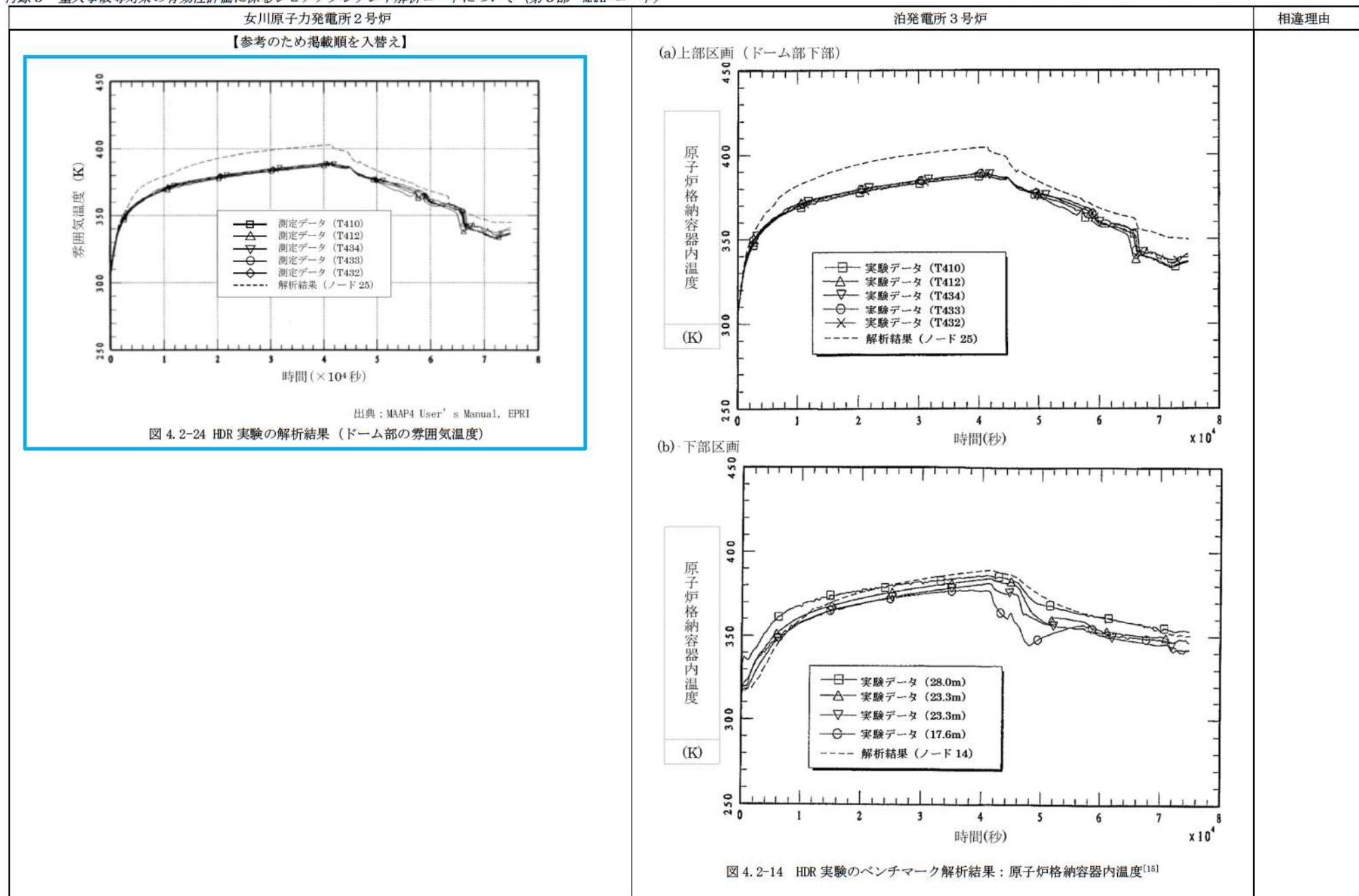
図 4.2-14 HDR 実験のベンチマーク解析結果：原子炉格納容器内温度<sup>[15]</sup>
