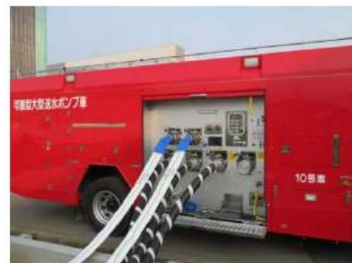
可搬型大型送水ポンプ車 周辺のホース敷設 （屋外）
