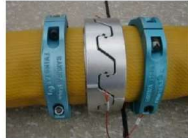
可搬型ホース（150A）接続後
