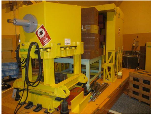
検出器回転架台
