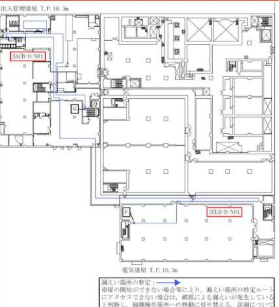
図2 地震時の隔離操作時におけるアクセス通路 (6/14)
