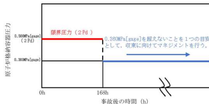
図5 原子炉格納容器圧力の168時間以降の考え方
