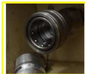
可搬型代替電源車の給油口へのホース接続（クイックカップラ式） （可搬型代替電源車） （屋外）
