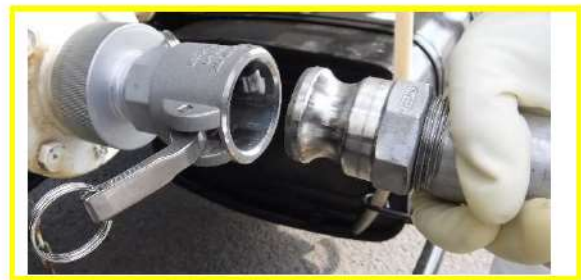
可搬型タンクローリーへのホース接続（継手接続式）（屋外）
