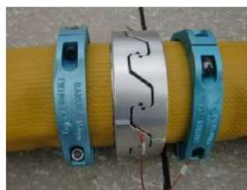
可搬型ホース(150A)接続後
