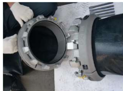
可搬型ホース(300A)接続
