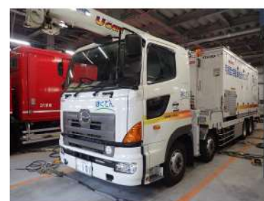
可搬型大容量 海水送水ポンプ車
