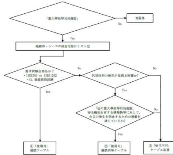
第1図：難燃性ケーブル確認方法
