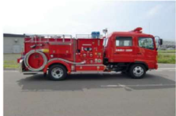
第 2 図：水槽付消防ポンプ自動車
