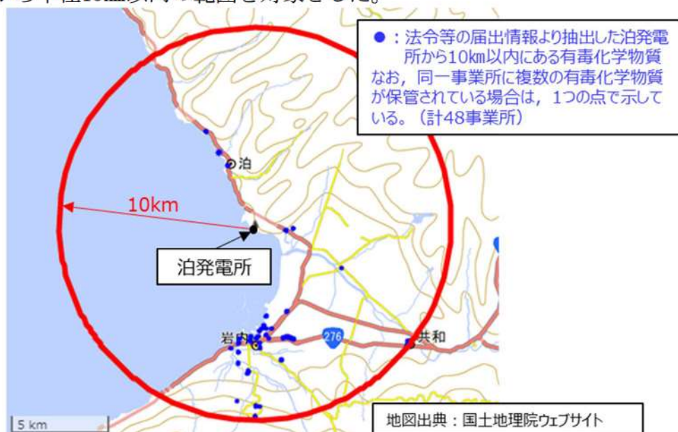
第3.1.3-1図 届出情報から抽出した泊発電所から半径10km以内にある有毒化学物質
