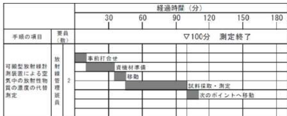
第 1.17-8 図 可搬型放射線計測装置による空気中の放射性物質の濃度の代替測定の実績タイムチャート
