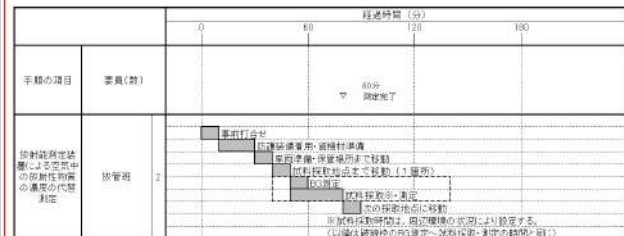
第 1.17.8 図 放射能測定装置による空気中の放射性物質の濃度の代替測定の実績タイムチャート
