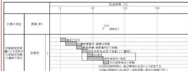
第 1.17.8 図 放射能測定装置による空気中の放射性物質の濃度の代替測定の実績タイムチャート
