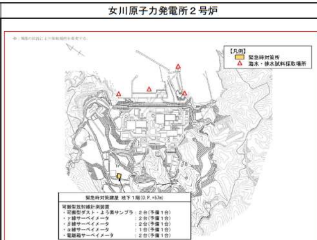
第 1.17-7 図 可搬型放射線計測装置の保管場所及び海水・排水試料採取場所
