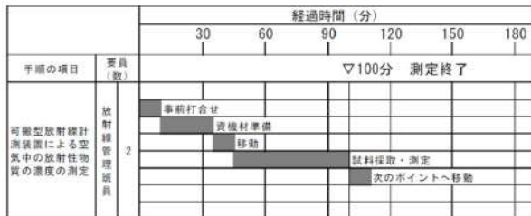
第 1.17-9 図 可搬型放射線計測装置による空気中の放射性物質の濃度の測定の実績タイムチャート
