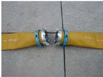
可搬型ホース(150A)接続前
