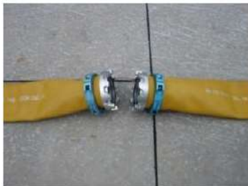
可搬型ホース(150A)接続前
