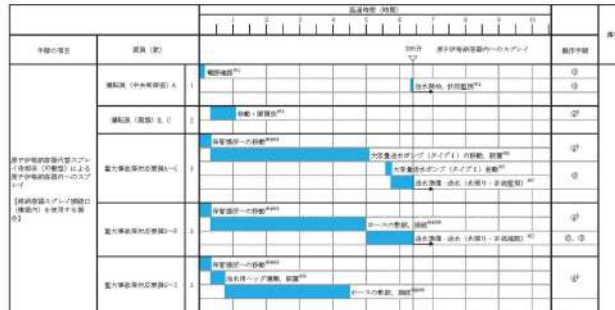
第1.6-15図 原子炉格納容器代替スプレイ冷却系（可搬型）による原子炉格納容器内へのスプレイ タイムチャート
