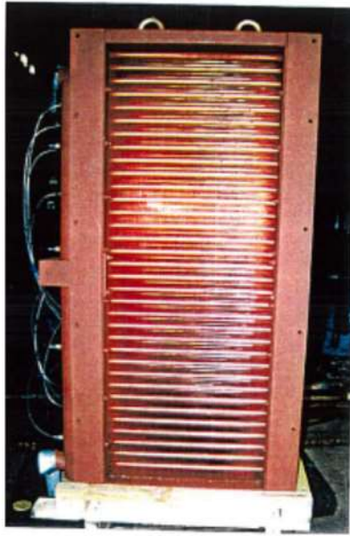
冷却水ヘッダー部 (冷却水温度計測用熱伝対取付状態)
