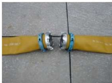
可搬型ホース（150A）接続前
