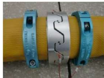
可搬型ホース（150A）接続後
