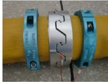
可搬型ホース（150A）接続後
