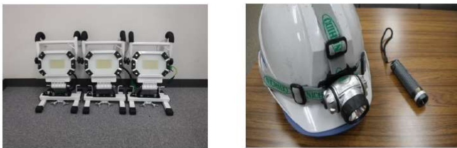
図 18 可搬型照明（SA）及び可搬型照明（ヘッドライト）等
