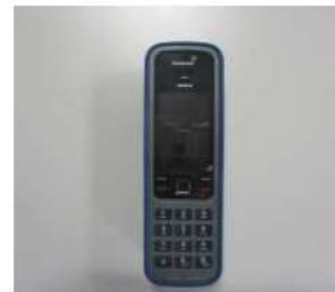
衛星電話設備 衛星電話設備（携帯型）
