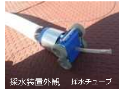
配管内サンプリングホース挿入
