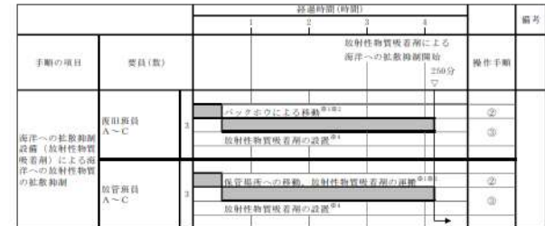
第1.12.7図 海洋への拡散抑制設備（シルトフェンス）による海洋への放射性物質の拡散抑制 タイムチャート
