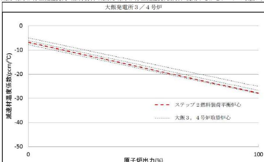
図2 高温零出力時と高温全出力時の減速材温度係数\*
