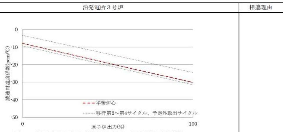
図2 高温零出力時と高温全出力時の減速材温度係数\*
