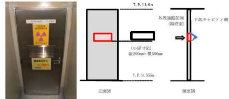
図8 □原子炉下部キャビティ入口扉小扉
