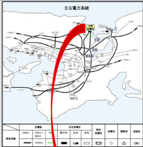
第10.3.1図 送電系統図（平成27年2月時点系統図）
