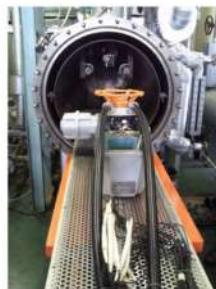
図2 蒸気曝露試験装置
