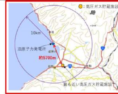
図 3-9 高圧ガス貯蔵施設位置
