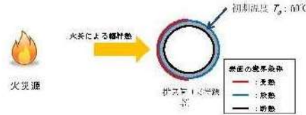
第3-8図 排気筒の評価概念図
