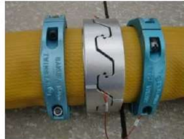
可搬型ホース（150A）接続後
