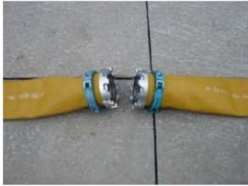
可搬型ホース（150A）接続前
