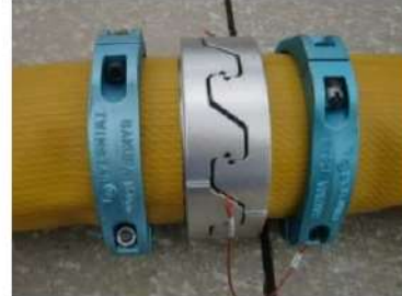
可搬型ホース（150A）接続後
