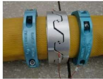
可搬型ホース（150A）接続後
