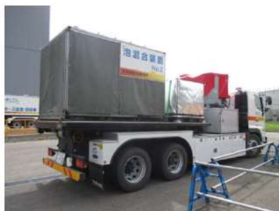
泡混合設備運搬
