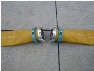
可搬型ホース(150A)接続前
