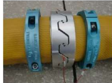
可搬型ホース(150A)接続後
