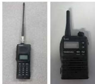
無線連絡設備 無線連絡設備（携帯型）
