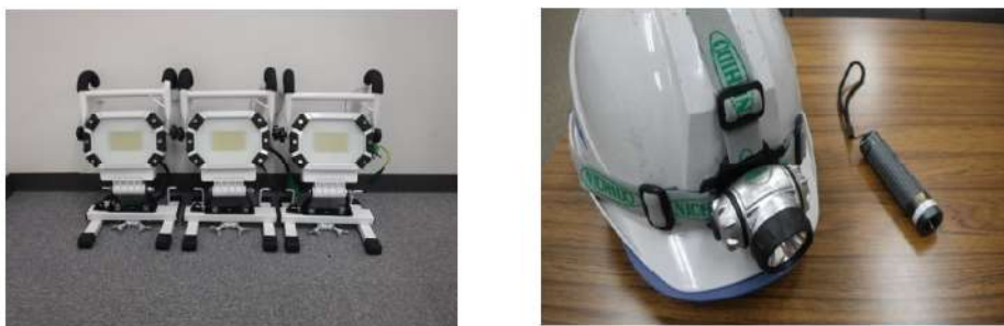
図 18 可搬型照明（SA）及び可搬型照明（ヘッドライト）等
