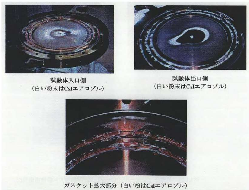
図 4-4 NUPEC 試験で用いたフランジ・ガスケットの損傷状態 (200℃を超過して約 0.5℃/min の昇温速度で加熱，漏えい発生後，温度を低下させ，エアロゾル捕集特性試験を実施した後の状態)
