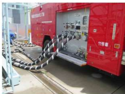
【図1 可搬型大型送水ポンプ車】
