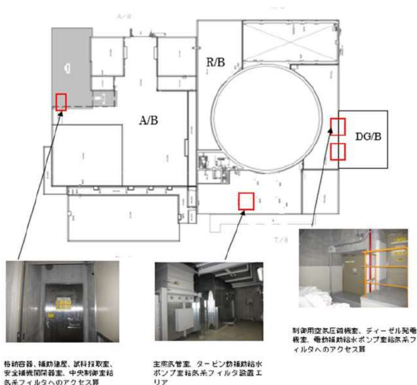
第2図 換気空調設備の外気取入口（フィルタ）へのアクセス例
