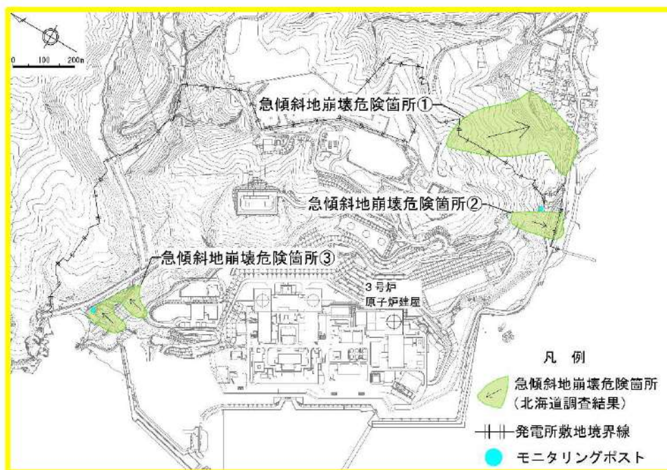
第 3.5 図 泊発電所周辺の急傾斜地崩壊危険箇所及び対象施設（安全施設）位置図
