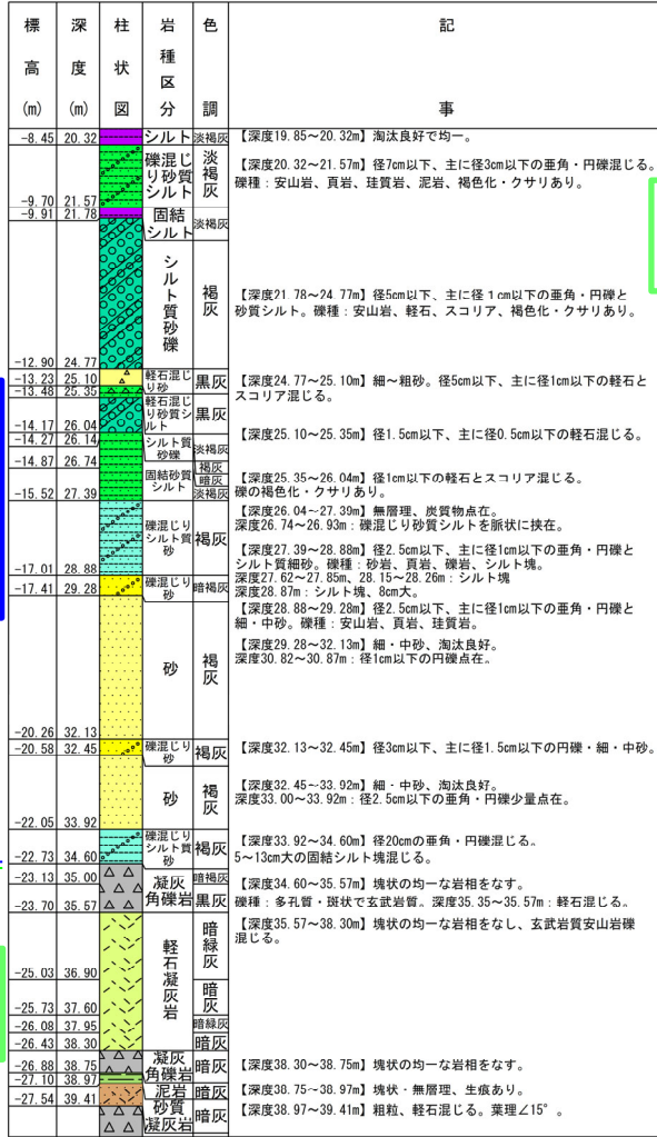
ボーリング柱状図(深度20~40m)
