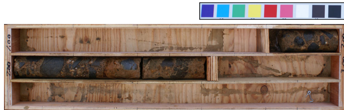
コア写真(別孔 深度1.8~2.6m)(2010年4月撮影)
