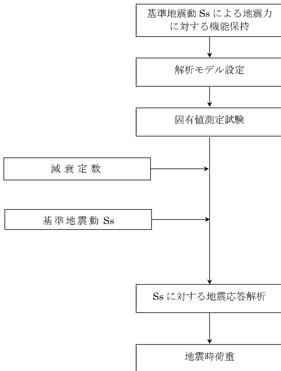
第4-1図 火災感知設備の地震応答解析フロー
