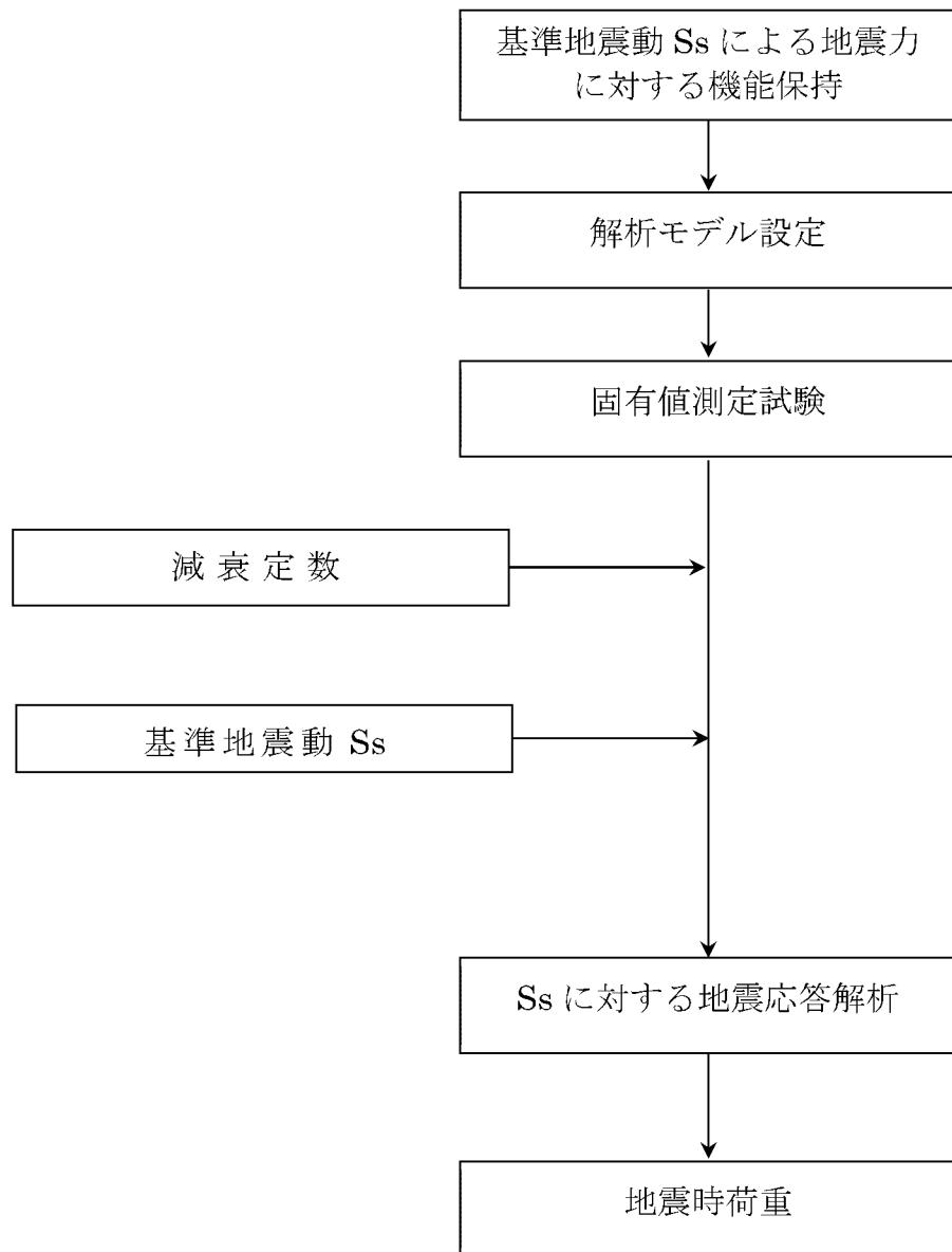
第 4-1 図 火災感知設備の地震応答解析フロー
