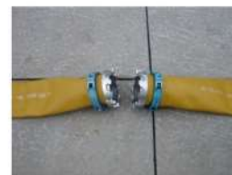
可搬型ホース（150A）接続前
